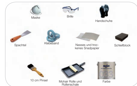
Ausrüstung zum Streichen
