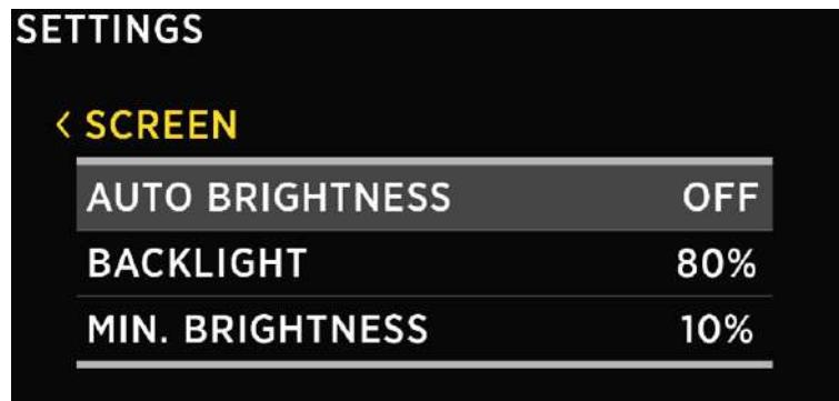
**AUTO BRIGHTNESS** - Wenn die automatische Helligkeitseinstellung aktiviert ist, passen die internen Lichtsensoren die Helligkeit des Bildschirms automatisch an die Lichtverhältnisse der Umgebung an.
