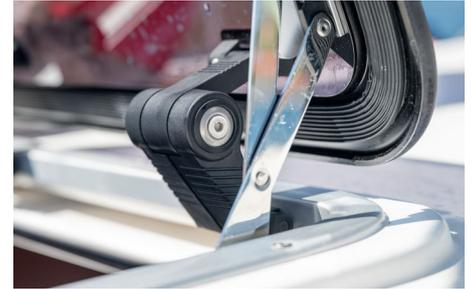
**Selbsttragendes Design:** Der Reibungshebel-Mechanismus sorgt für einen sicheren Halt der Ultra-Low-Profil-Luke in verschiedenen Winkeln.
