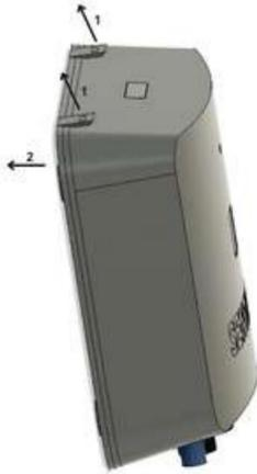
2. Befestigen Sie die Halterung mit den mitgelieferten selbstschneidenden Schrauben oder Klebeband an der Wand. Achten Sie darauf, die Ausrichtung der Halterung beizubehalten, da die oberen und unteren Clips an der Halterung unterschiedlich sind. Die oberen Clips sind länger als die unteren.
