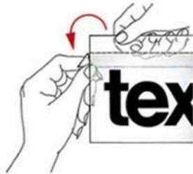
3. Klebeleiste der Montagefolie durch Umknicken der Grundfolie an der Perforation freilegen.
