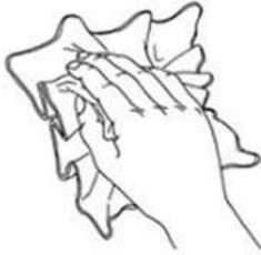
1. Untergrund reinigen und Kleberabweisende Substanzen entfernen.
