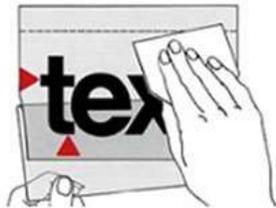
5. Grundfolie nach unten wegziehen und gleichzeitig den Schriftzug mit der Montagefolie anraken.
