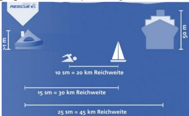
Die Reichweite des Rettungssenders beträgt etwa 5-10sm Seemeilen, bei Betrieb knapp über der Wasseroberfläche. Befindet sich der Rettungssender mehr als 1m über der Wasseroberfläche, beträgt die Reichweite ca. 10-15sm (bei einer Empfangsantennenhöhe von ca. 15 m).
