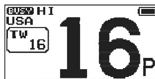
5. Wenn eine Übertragung auf dem Prioritätskanal empfangen wird, bleibt das **HX320E** auf dem Prioritätskanal, bis das eingehende Signal verschwindet.
