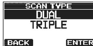
**DUAL** (Dual Watch): Das **HX320E** überwacht die Aktivität des aktuellen Kanals und des Prioritätskanals.
