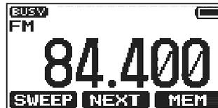
3. Um den UKW-Rundfunkempfangsmodus zu verlassen, die Taste **[MENU/SET]** drücken, um das MENU-Display anzuzeigen, dann den Softkey **[CH]** drücken. Das Funkgerät kehrt zu dem Kanal zurück, der vor dem Schalten in das UKW-Rundfunkband in Gebrauch war.
