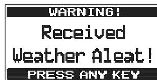
Nach Stoppen des Pieptons wird das Display zur Bestätigung des Empfangs von Wetterwarnungen angezeigt. Drücken Sie eine beliebige Taste, um das Bestätigungsdisplay anzuzeigen. Das Bestätigungsdisplay fragt, ob zum Wetterkanal gegangen oder zum Seefunkkanal zurückgekehrt werden soll. **[YES]** drücken, um zum Wetterkanal zu schalten oder **[NO]** drücken, um zum Seefunkkanal zurückzukehren.
