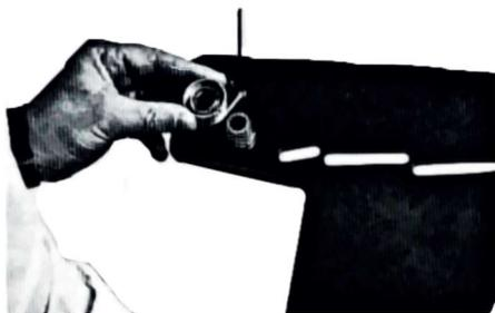
2. Die Spiralfedern (F) liegen in Links- und Rechtsausführung vor. Die Feder mit grüner Farbmarkierung ist für das rechte Ruderblatt bestimmt und die mit roter Farbmarkierung für das linke. Die Federn über Lager des Ruderblatts mit dem farbmarkierten Federbein im rückwärtigen Justierloch anbringen (Pfeilmarkierung beachten).
