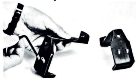
1. Imbusschrauben (C) in Halterungen einschrauben, jedoch nicht durch die Platte schrauben. Bitte beachten, dass die Schrauben gerade in die schrägen Gewindelöcher eingeführt werden. Die Gewindelöcher sollten eingefettet sein.
