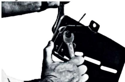
4. Den Bolzen mit Schraubenschlüssel ansiehen und schliessen, indem die niedrige Schlossmutter fest angezogen wird, die am Bolzenende sitzen soll (siehe Pfeilmarkierung).
